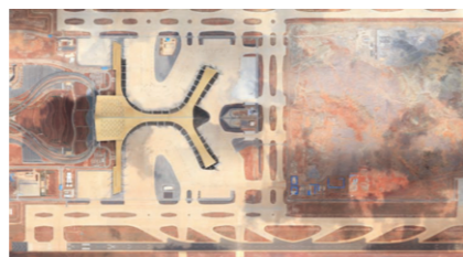
云南机场建设前基于航空影像图进行工程勘测和规划设计
